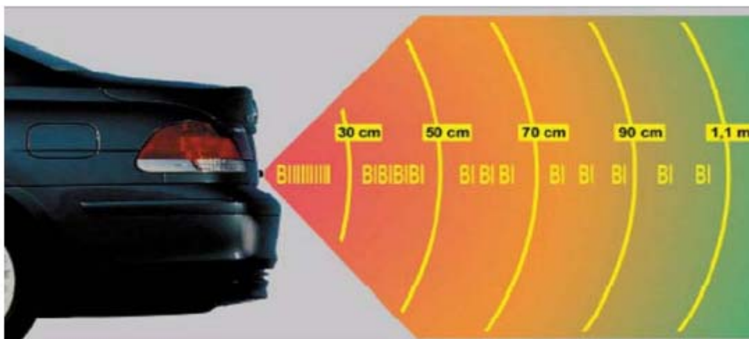
Figure 1. Assistance au stationnement à l'aide de radar à ultrasons
